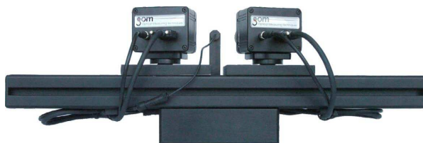
Rys. 4. Układ dwóch kamer systemu ARAMIS
