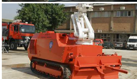
Rys. 10. Chorwacki robot gaśniczy wyposażony w działko wodne na manipulatorze
