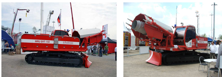
Rys. 12. Gąsienicowy robot gaśniczy ( v_{max}=3\text{km/h} , m=17500\text{kg} , Q=150\text{ dm}^3/\text{s} ) [7]
