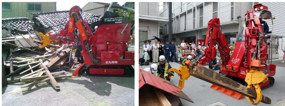
Rys. 14. Japoński robot wsparcia na bazie mini-koparki
