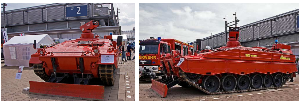
Rys.6. Opancerzony pojazd gaśnicowy wykorzystywany przez jednostki straży pożarnej
