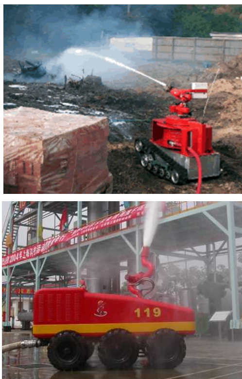
Rys.7. Zdalnie sterowane roboty pożarnicze minimalizujące bezpośrednie zagrożenie człowieka
