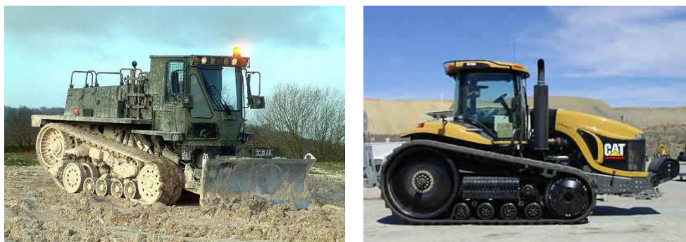
Rys.5. Opancerzona maszyna DEUCE oraz ciągnik Challenger z hydrauliczną dystrybucją obciążeń na podłoże
