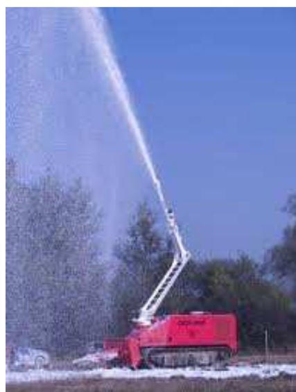
Rys. 10. Chorwacki robot gaśniczy wyposażony w działko wodne na manipulatorze
