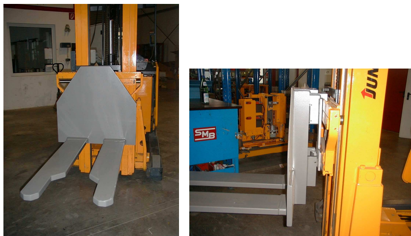
Rys. 5. Wózek przystosowany do obsługi systemu DIS-2, wyposażony w „normalne” widły.
