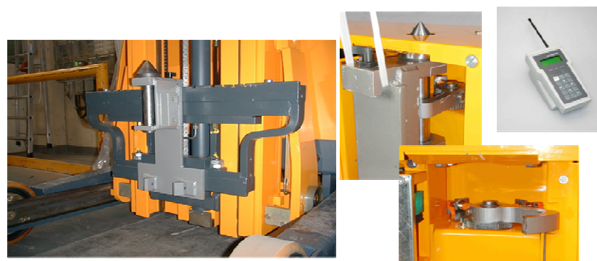
Rys. 4. Sposób mocowania karetki samojezdnej DIS-2 na karetkę wózka widłowego.
