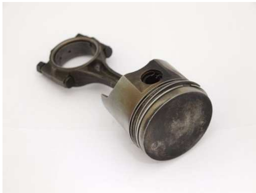
Rys. 2. Tłok silnika samochodu Fiat 126p wraz z korbwodem przed modyfikacją laserową
