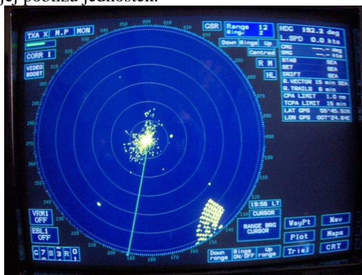
Rys.1. Obraz farmy elektrowni na ekranie radaru KH 3000 (Zdjęcie autora)
