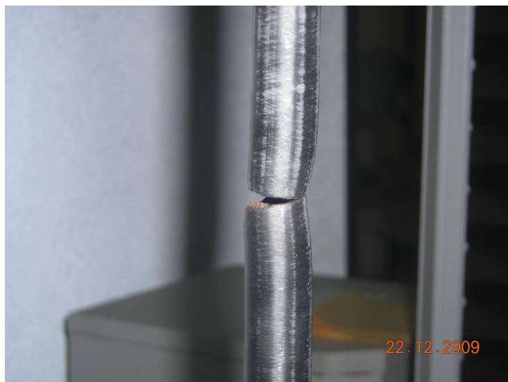
Rys. 3. Widok próbki skorodowanej w komorze mgły solnej po wykonaniu badań wytrzymałościowych
