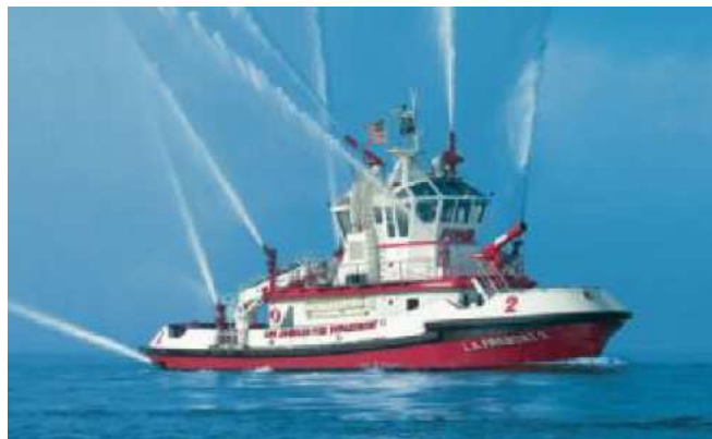
Rys. 2. „LA Fireboat 2” jednostka ppoż. z napędem VSP na potrzeby portu Los Angeles [3]
