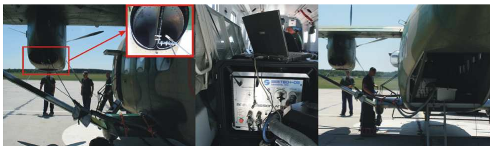
Rys. 3. Miejsce zamocowania sondy poboru spalin i umieszczenia analizatora
