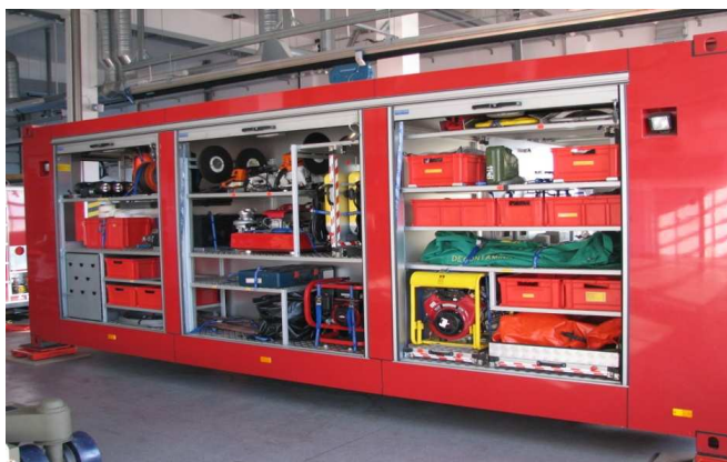
Rysunek 3. Kontener ratownictwa technicznego Źródło: Zdjęcie własne autora.
