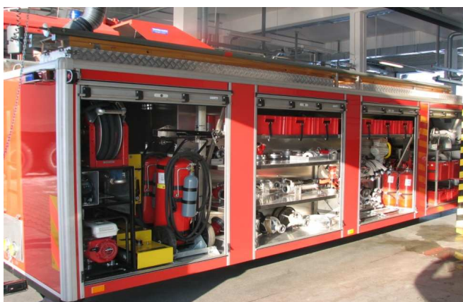
Rysunek 4. Kontener specjalny ze sprzętem gaśniczym i zbiornikiem na środek pianotwórczy Źródło: Zdjęcie własne autora.
