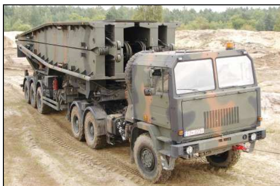
Rys.7. Most towarzyszący na podwoziu samochodowym MS-20
