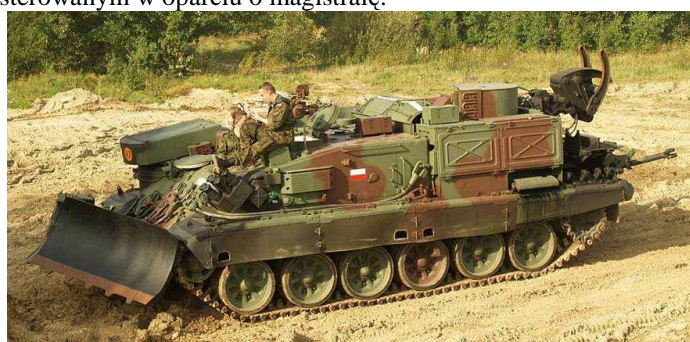
Rys.4. Maszyna Inżynieryjno Drogowa MID
