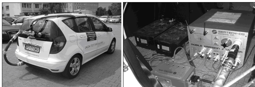
Rys. 1. Widok pojazdu podczas badań z zamontowanym analizatorem SEMTECH DS
