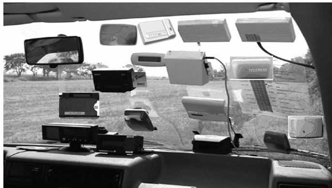
Rys. 3. Urządzenia pokładowe OBU aktualnie stosowane w pojeździe [4]
