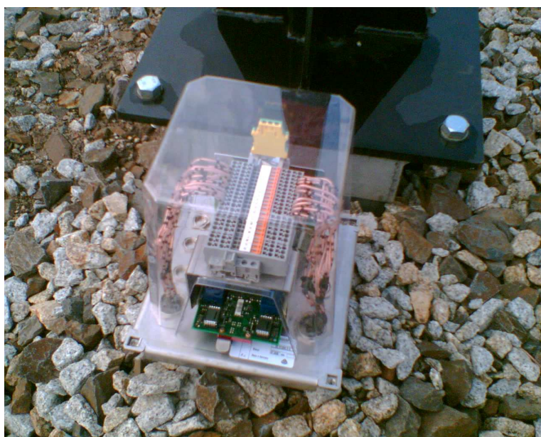
Fot. 2 Moduł elektroniczny sygnalizatora świetlnego LSS-BG.
