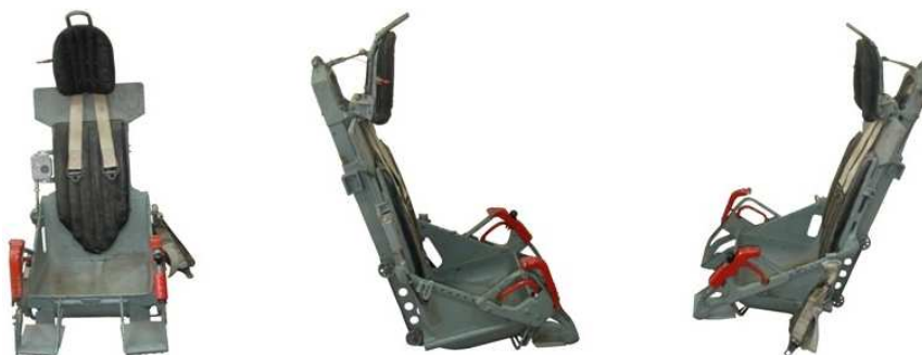
Rys.2. Fotel katapultowy SK wykorzystany do opracowania modelu
