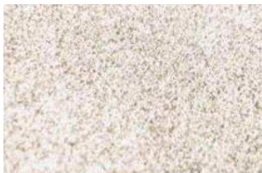
Rys. 4. Wygląd zewnętrzny powłoki cynkowej przy powiększeniu 100x. a) polaryzacja w zakresie od Est do - 1500mV; b) polaryzacja w zakresie od Est do - 2800mV; z prędkością zmian potencjału względem elektrody EAgClP – 311T równej v = 20\text{mV/s} . i zatrzymaniem procesów w czasie 5 min
