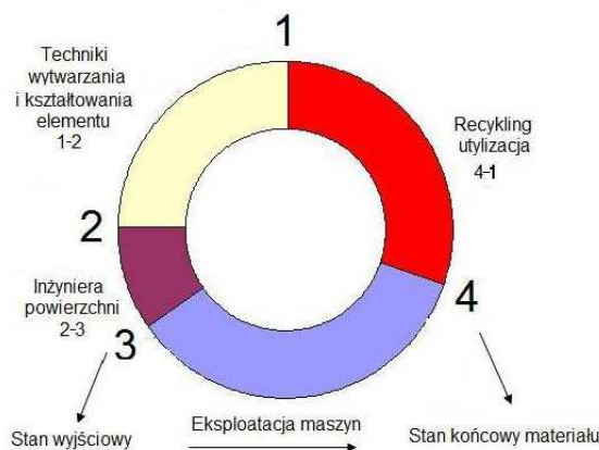
Rys.1. Zamknięty cykl obiegu materiałów konstrukcyjnych w technice: 1-2 –wytwarzanie elementu; 2-3 – modyfikacja stanu materiału metodami inżynierii powierzchni; 3-4 – eksploatacja urządzenia; 4-1 – recykling, utylizacja
