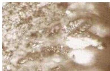
Rys. 4. Wygląd zewnętrzny powłoki cynkowej przy powiększeniu 100x. a) polaryzacja w zakresie od Est do - 1500mV; b) polaryzacja w zakresie od Est do - 2800mV; z prędkością zmian potencjału względem elektrody EAgClP – 311T równej v = 20\text{mV/s} . i zatrzymaniem procesów w czasie 5 min
