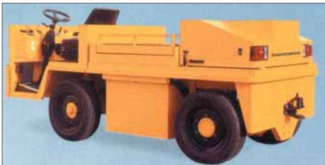
Rys. 2. Wózek jezdniowy ciągnikowy (ang. towing traktor ). Źródło: Materiały informacyjne firmy STILL.
