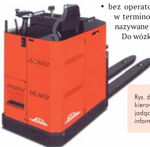
Rys. 3. Wózek jezdniowy pchający (ang. pushing traktor ). Źródło: PN-ISO 5053:1999.
