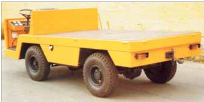
Rys. 1. Wózek jezdniowy naładowny platformowy (ang. fixedheight load-carrying truck ). Źródło: materiały informacyjne firmy Jungheirich.
