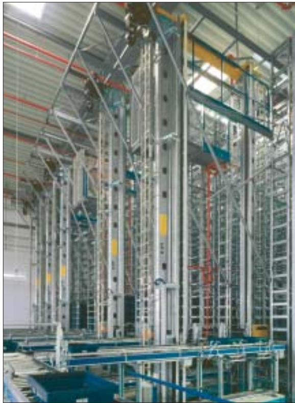
Fot. 1. Dzięki zastosowaniu dodatkowego napędu anty-wahadłowego (AP), pozycjonowanie układnic Mustang i Stratus jest wyjątkowo szybkie i dokładne
