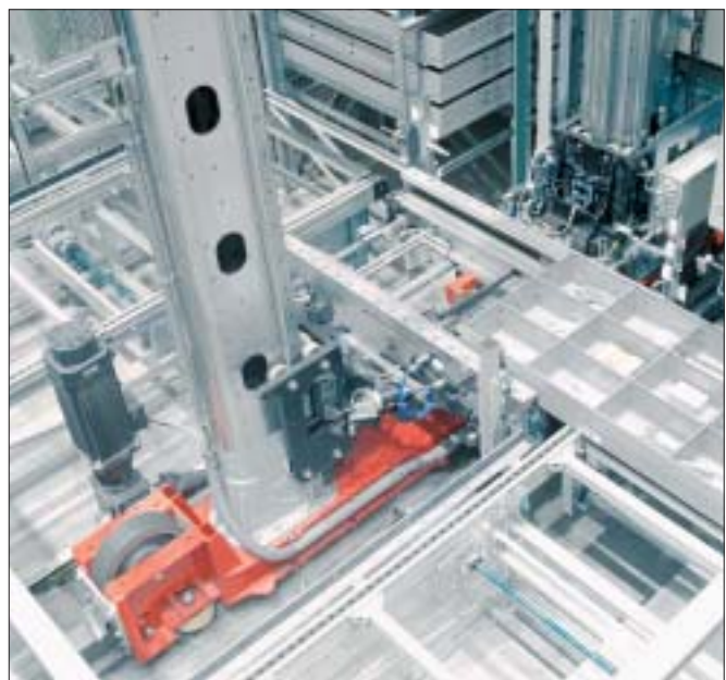
Fot. 4. Spectra T przejmuje w strefie przeładunków tacz z komponentami do produkcji
