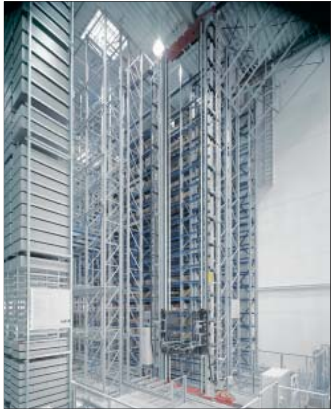
Fot. 3. Dzięki lekkiej konstrukcji, zaprezentowana w roku 2002 układnica paletowa Magnus osiąga bardzo wysokie wartości prędkości i przyspieszeń
