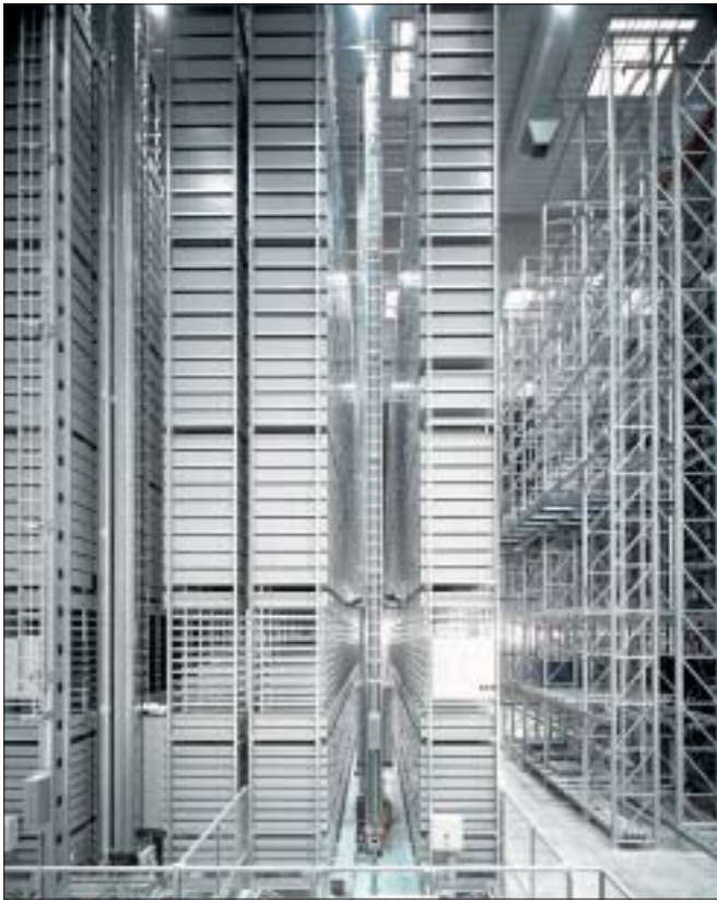
Fot. 2. Zaprezentowana w roku 2002 układnica dwumasztowa Stratus z firmy TGW została zastosowana również w firmowym centrum logistycznym do obsługi nośników ładunków typu taca
