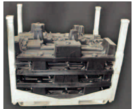
Rys. 4. Paleta ładunkowa z przekładkami do kolumn kierowniczych. Źródło: materiały informacyjne producenta
