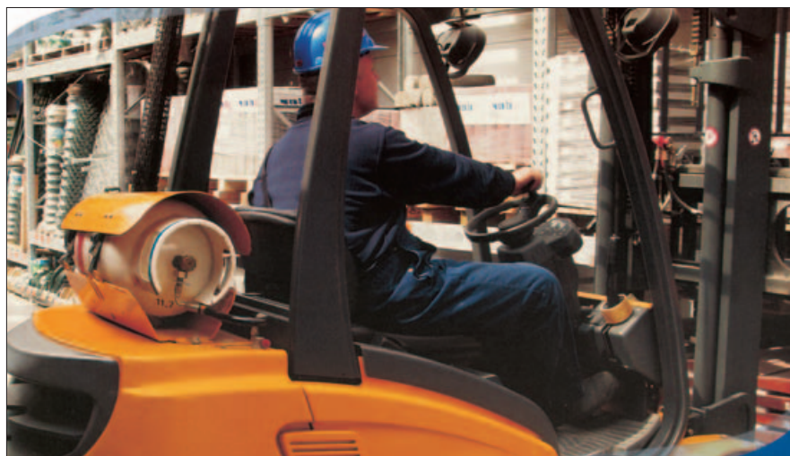
Fot. 1. Wózek jezdniowy napędzany podnośnikowy z zamontowaną butlą stalową. Źródło: Materiały informacyjne firmy ORLEN GAZ
