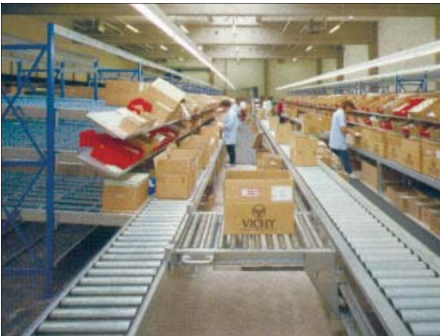
Fot. 3. Zmechanizowany system kompletacji przy zastosowaniu układu regałów przepływowych i przenośników wałkowych. Źródło: materiał informacyjny firmy Dexion
