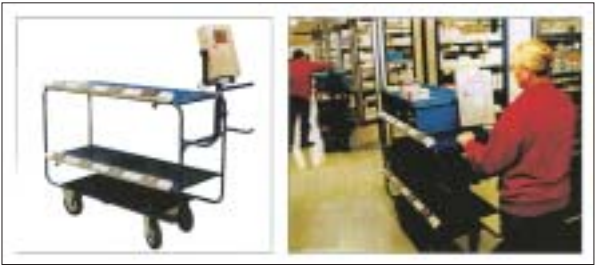
Fot. 1. Ręczny system kompletacji za pomocą wózka platformowego, wyposażonego w monitor, na który drogą radiową są przekazywane dyspozycje wydań. Źródło: [3]
