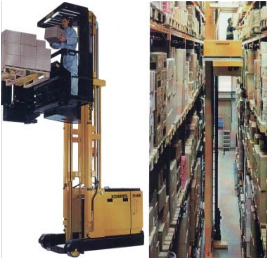
Fot. 2. Zmechanizowany system kompletacji w miejscu składowania przy pomocy: wózka podnośnikowego kompletacyjnego (z prawej) oraz układnicy kompletacyjnej. Źródło: materiały informacyjne firm Steinbock i Jungheinrich.
