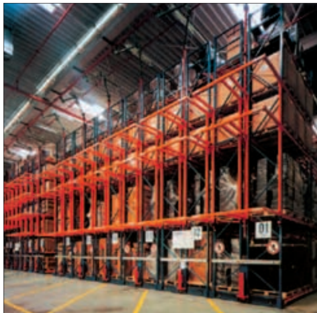
Fot. 2. Regał ramowy paletowy przejezdny. Źródło: Katalog Nedcon Silesia.
