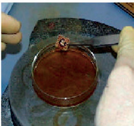
Rys. 1 Rozpuszczanie żywicy epoksydowej przez kwas azotowy Źródło: M. Kubn, O. Kömmerling, „Design Principles for Tamper-Resistant Smartcard Processors,” Proceedings of the USENIX Workshop on Smartcard Technology (Smartcard '99) , Chicago, Illinois, 10–11 maja 1999.
