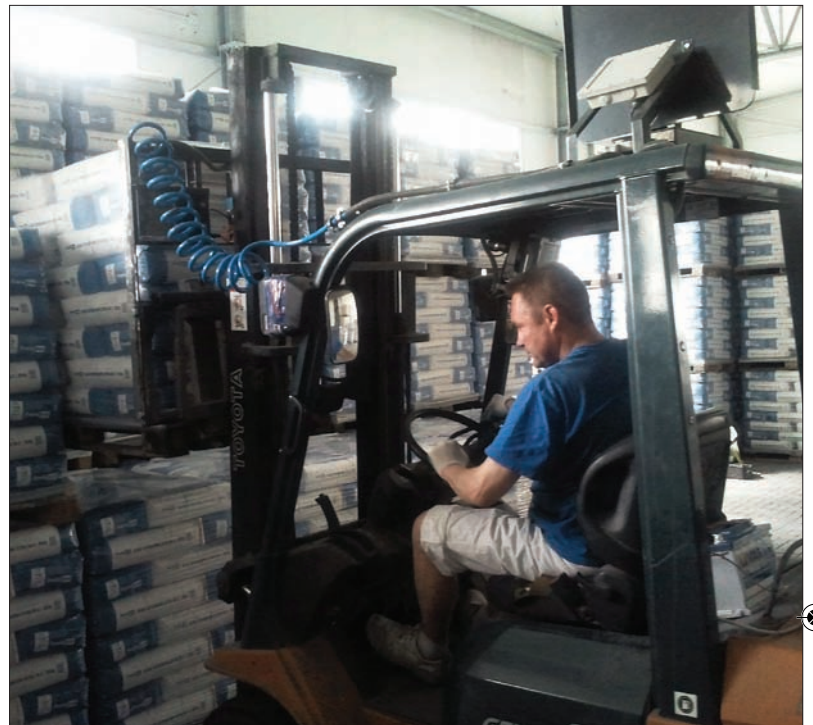
Fot. 1. Praca wózka widłowego z czytnikiem i antenami RFID. Opracowanie własne autora
