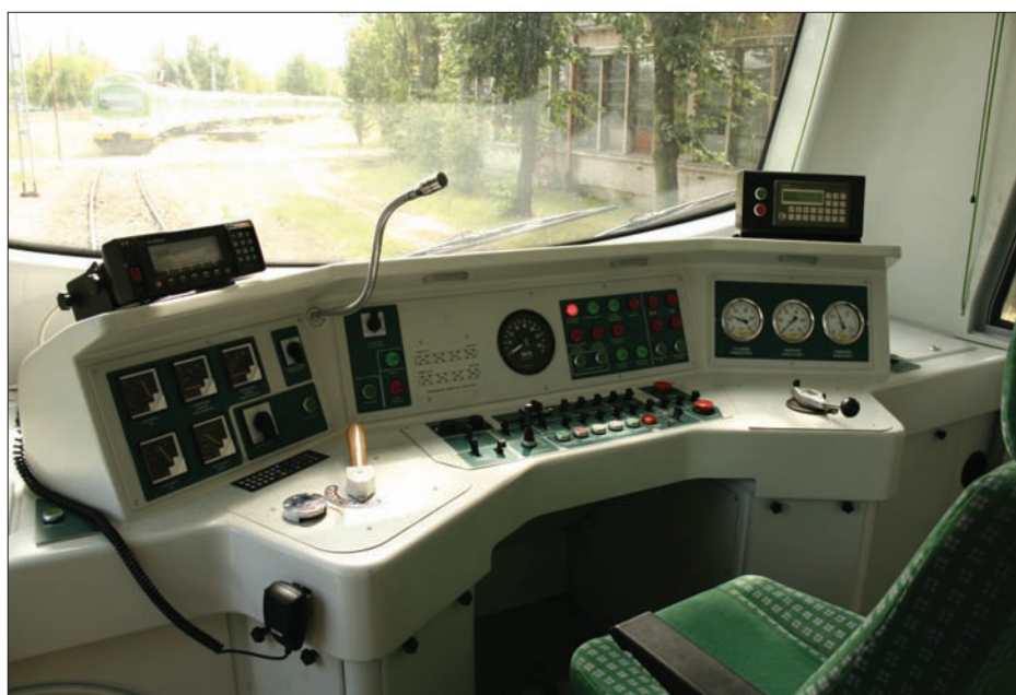
Zmodernizowana kabina maszynisty w EZT EN71 (źródło: KM Sp. z o.o.).
