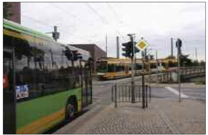
Fot. 1. Pasy autobusowo – tramwajowe jako przejaw integracji środków transportu zbiorowego w Zagłębiu Ruhry (na zdjęciu przystanek przy dworcu Oberhausen Hbf).
