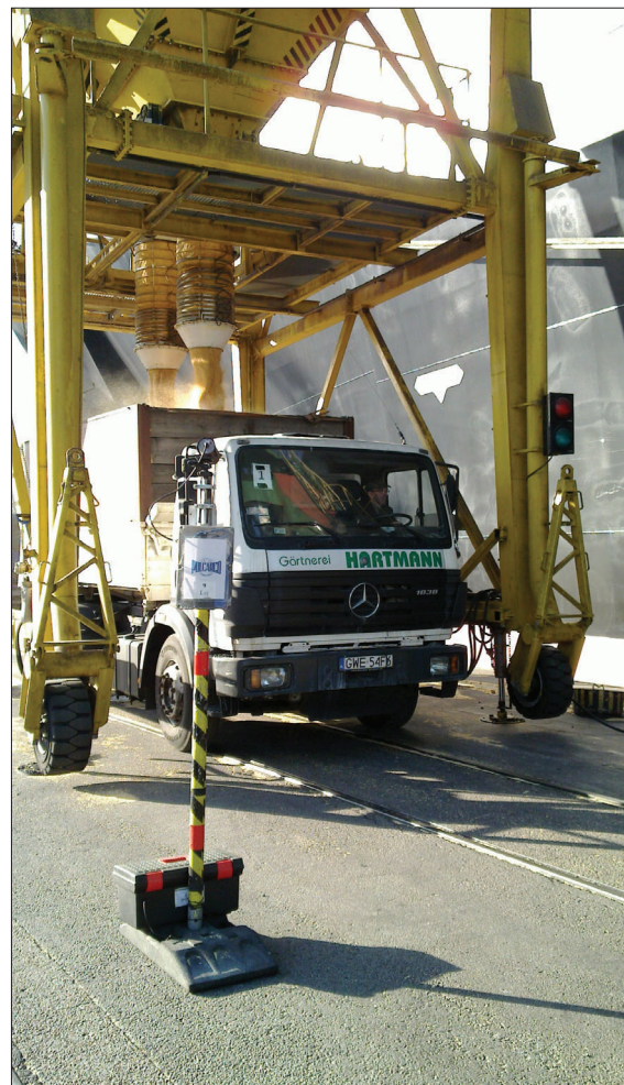
Fot. 4. Ważony i identyfikowany pojazd z aktywnym tagiem RFID (fot. własność Polcargo).
