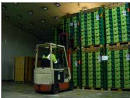
Wnętrze jednego z magazynów Eastpack, z zainstalowanymi w suficie znacznikami lokalizacyjnymi, służącymi do określania położenia palet. Źródło: SCAN, issue No. 24 May 2008, EPC/RFID Arrives! New Zealand's first major roll-out, s. 5.
