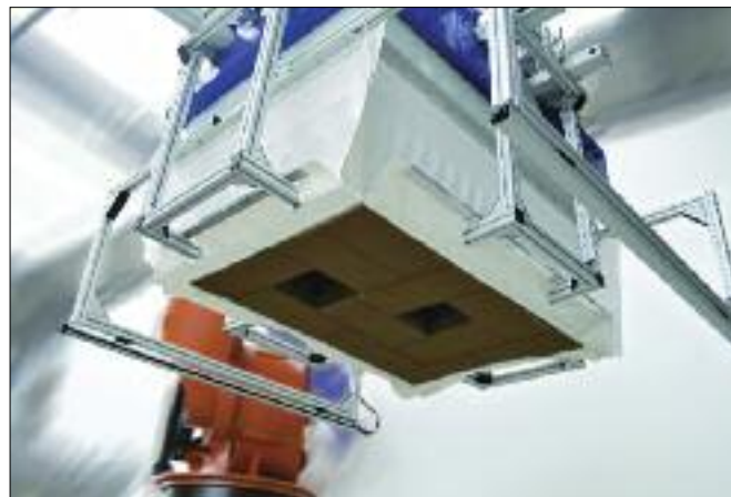
Fot. 2. Chwytak podciśnieniowy firmy SCHMALZ. Źródło: Materiały firmy J. Schmalz GmbH.
