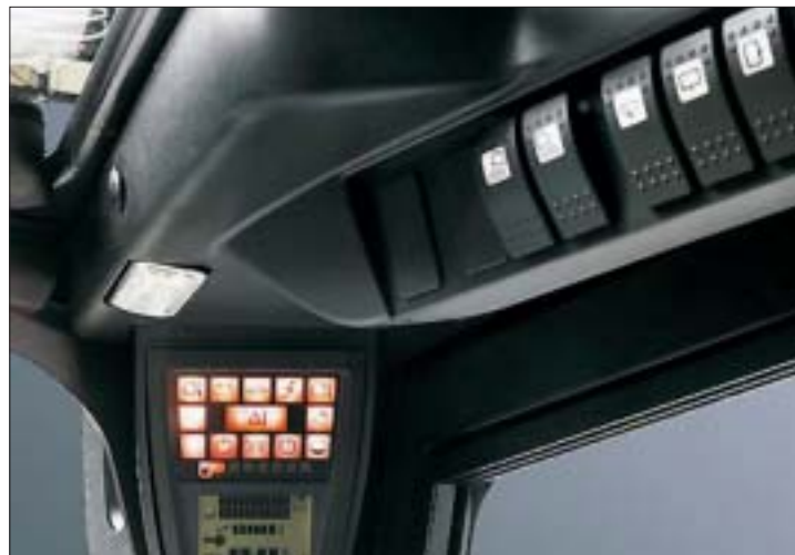
Rys. 4. Rozmieszczenie wyposażenia kontrolnego oraz wskaźników. Źródło: Materiały informacyjne Linde Material Handling Polska
