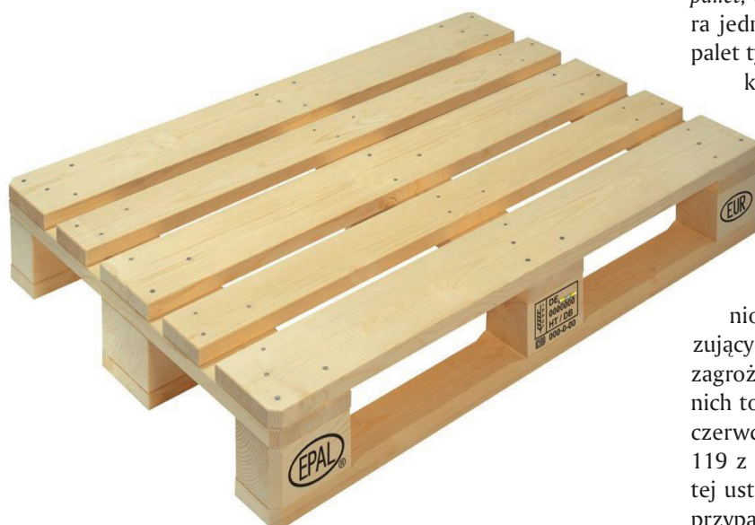
Rys. 1. Paleta ładunkowa płaska drewniana czterowejściowa typu EUR, o wymiarach płyty nośnej 800 mm x 1200 mm Źródło: materiały informacyjne PKN EPAL.
