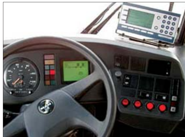
Rys. 3. Terminal zainstalowany na desce rozdzielczej pojazdu
