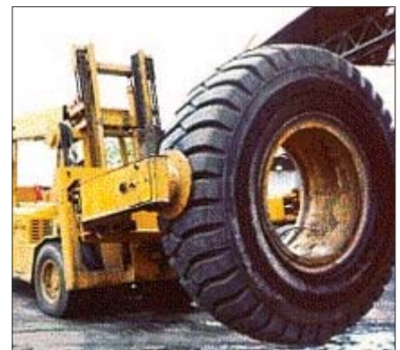
Rys. 6. Wózek podnośnikowy podczas pracy z chwytakiem do kół [4].
