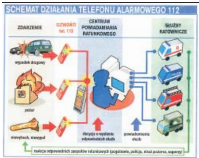
Rys. 3. Schemat działania telefonu alarmowego 112 (www.112.info.pl/)
