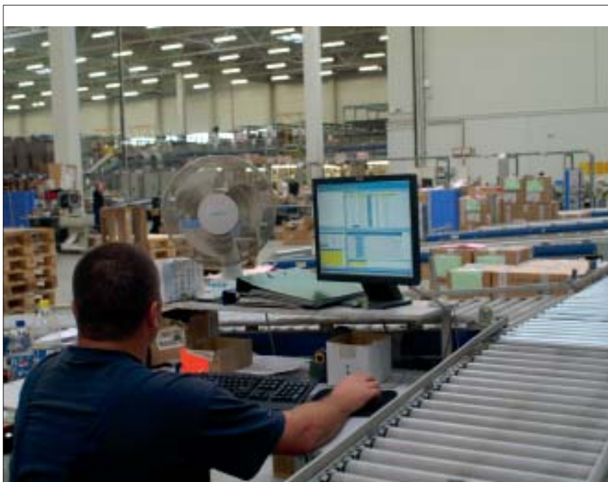
Sortowanie kartonów wysyłkowych na odpowiednie relacje i trasy klienckie (fot. Coty Polska).
