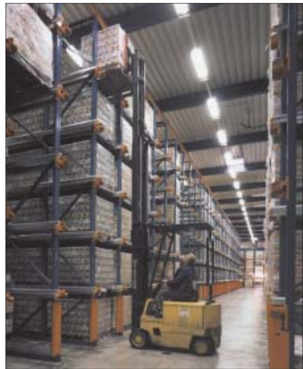
Rys. 1. Precyzyjne umieszczanie palety w regale wjezdnym przy użyciu bocznego przesuwu wideł (prześwit wg FEM 10.2.03 wynosi tylko 25 mm)
